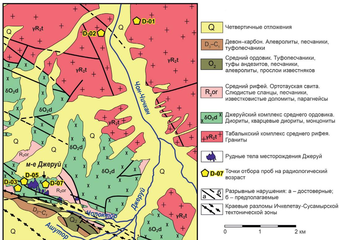
Рис. 2. Схема геологического строения Джеруйского рудного поля с местоположением пунктов отбора проб на радиологический возраст
